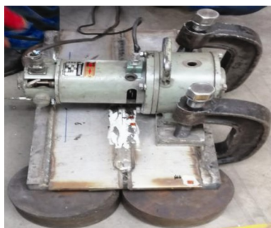
图4 机械振动时效处理
